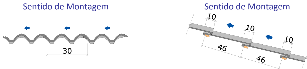
Figura 5 – Seqüência de montagem das telhas
